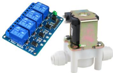
Fig.4. Módulo Relé de 4 canales con Electroválvula.
