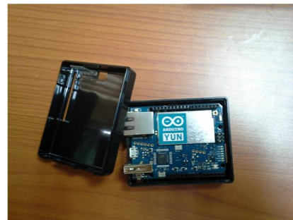
Fig.3. a.) Componentes principales de la placa Arduino Yun. b.) Placa Arduino Yun dentro de su caja de soporte
