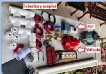
Fig. 1. Materiales utilizados para la construcción del prototipo.
