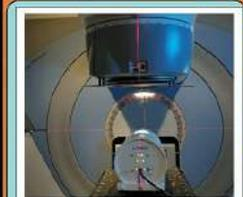
Figura 6. Almacenamiento de ArchCheck 3D con fantoma del LINAC
