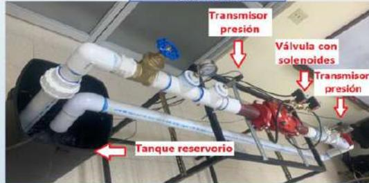
Fig. 2: Prototipo funcional ensamblado.
