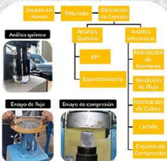
En el anterior esquema, se presentan los pasos requeridos para la preparación de las hojas de bambú en ceniza, la elaboración de los morteros y los métodos utilizados para el análisis del comportamiento de los morteros a causa de las cenizas como material cementante suplementario.
