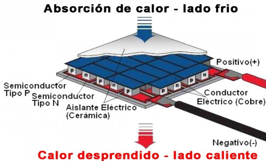
Figura 1. Funcionamiento de una celda Peltier. Fuente: techmake.com
