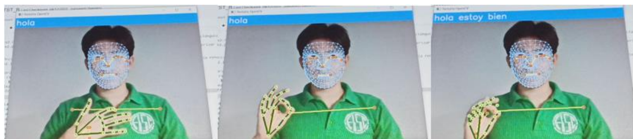
Ilustración 104 Sistema en ejecución. Posición neutral (izquierda), haciendo la seña para "hola" en LSP (centro), terminando la seña y con el resultado ya en pantalla (derecha). Fuente: el autor.
