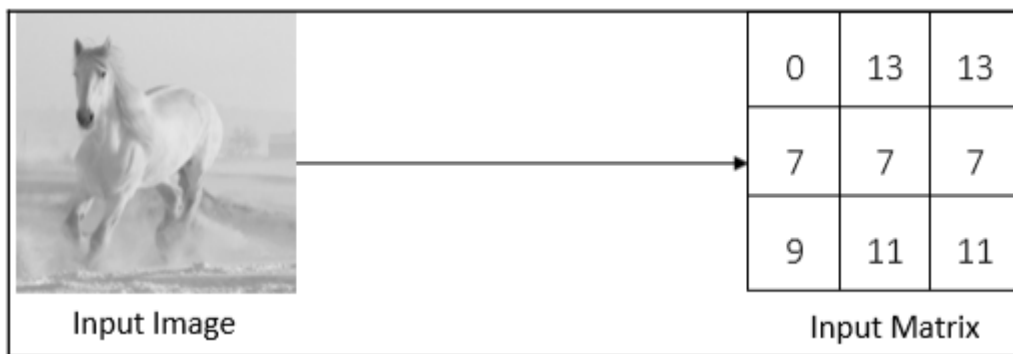
Ilustración 49 La entrada de tipo imagen (izquierda) se convierte a algo que pueda ser entendido por la computadora: una matriz de números (derecha). Fuente: obtenido de [31].
