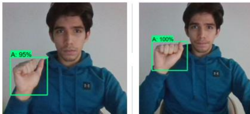
Ilustración 99 Modelo en ejecución con salidas con un 95% de confiabilidad (izquierda; seña con una rotación y separación del pulgar) y un 100% de confiabilidad (postura típica) para la letra "A" en LSP. Fuente: el autor.
