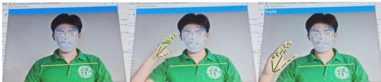
Ilustración 104 Sistema en ejecución. Posición neutral (izquierda), haciendo la seña para "hola" en LSP (centro), terminando la seña y con el resultado ya en pantalla (derecha). Fuente: el autor.
