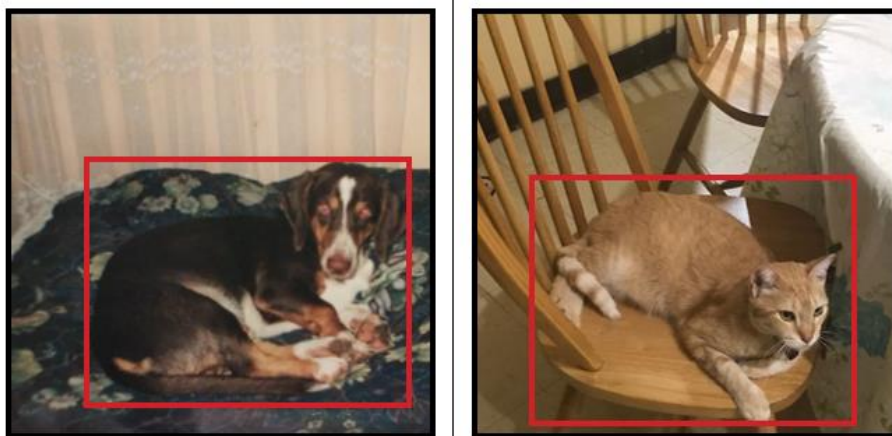
Ilustración 78 Salidas independientes de un localizador de objetos que reconoce perros y gatos, y los ubica en una imagen. Fuente: el autor.
