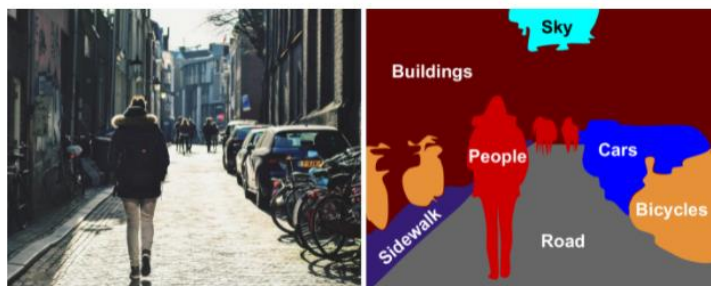
Ilustración 92 A la izquierda, una imagen de entrada; a la derecha, los efectos de aplicar sobre ella segmentación semántica. Fuente: obtenida de [24].
