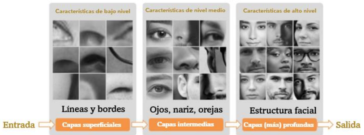
Ilustración 40 Extracción de características en una ConvNet. Fuente: adaptado de [27].
