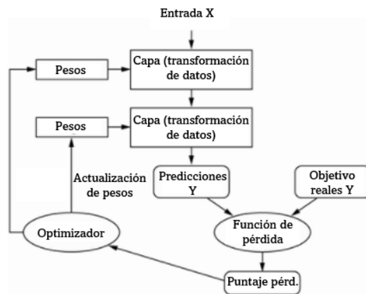
Ilustración 27 Puntaje de pérdida como valor para ajustar los pesos. Fuente: obtenido de [24].
