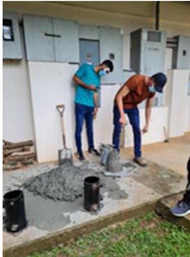
**Fuente propia.** Estudiantes del curso de Materiales de Construcción y Normas de Ensayo, en la medición del asentamiento especificado.
