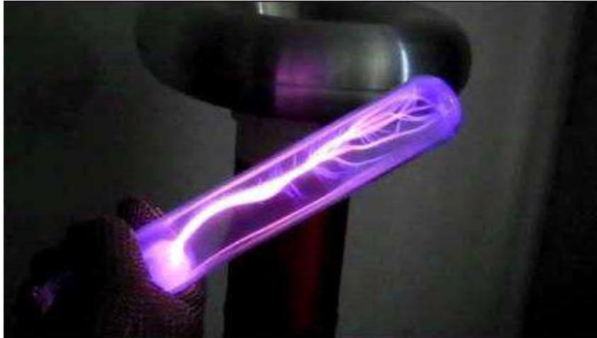
Figura 3-5. Descarga de arco dentro de un tubo al vacío.
