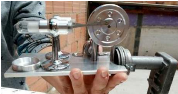
Figura 8. Acople del motor Stirling a la antena
