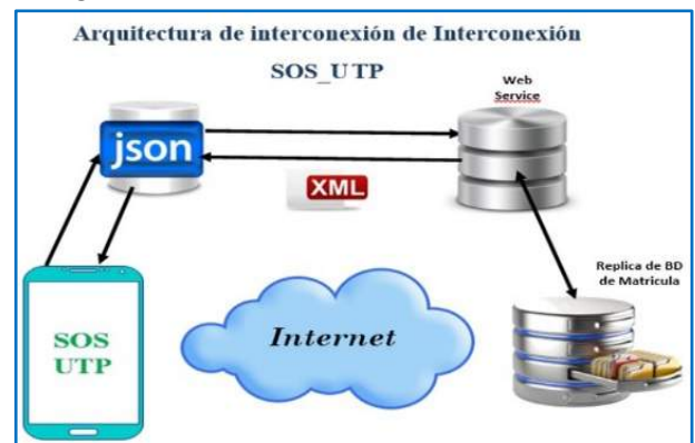
Figura 3. Arquitectura de Interconexión.
