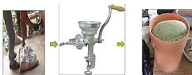
Figura 7. Procedimiento de trituración y molienda del vidrio de desecho. Almengor et al. (2017).
