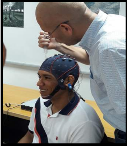
Figura 3. Sistema BCI no invasivo de 16 canales.
