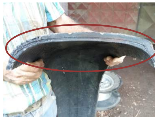
Figura 3. Sección transversal de neumático para vehículo.
