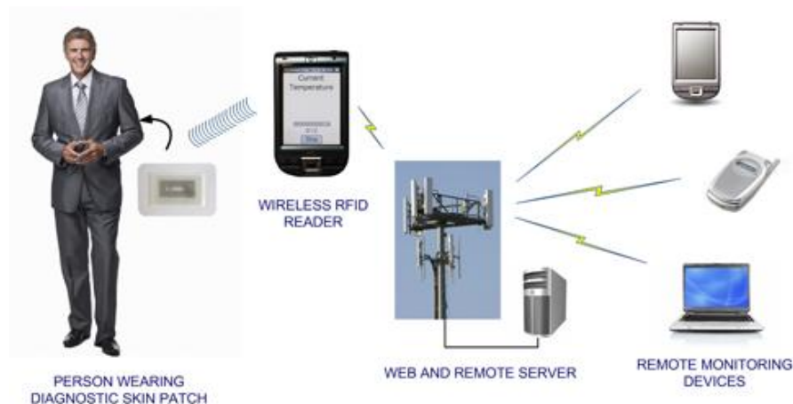
Figura 3-12. Esquema funcional de SenSAVE
