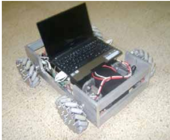
Figura 5. Robot Móvil de con ruedas mecanum desarrollado para la implementación de la arquitectura híbrida.
