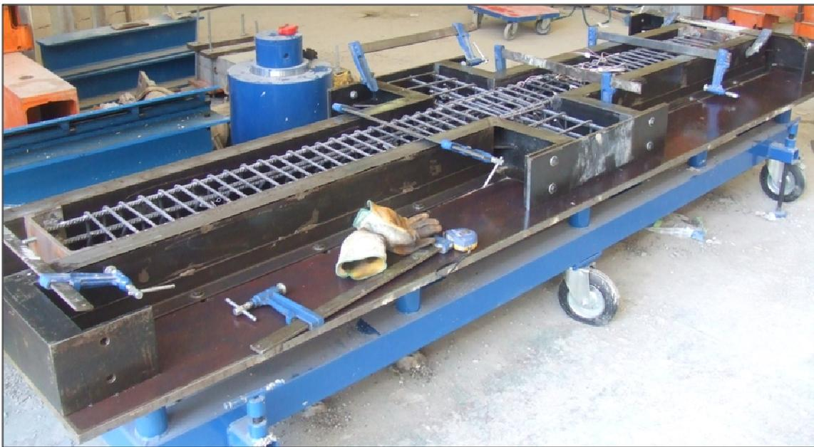
*Figura 4.18. Armadura en el encofrado auto-vibrante preparado para el hormigonado*
