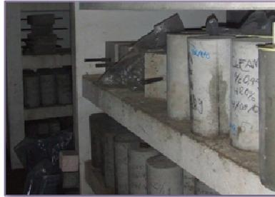
*Figura 4.22. Cámara húmeda donde se guardan las probetas de control por 28 días*
