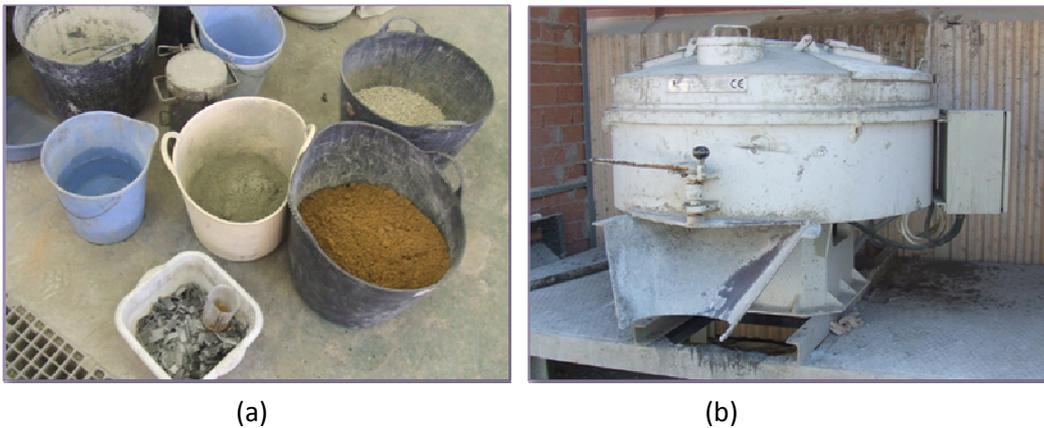
Figura 4.19. (a) Materiales separados para la fabricación del hormigón. (b) Amasadora de eje vertical
