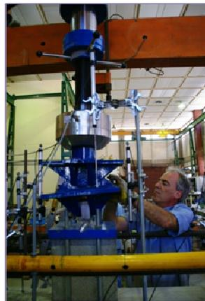
*Figura 4.33. Ajuste del actuador hidráulico de la fuerza vertical al soporte de ensayo*
