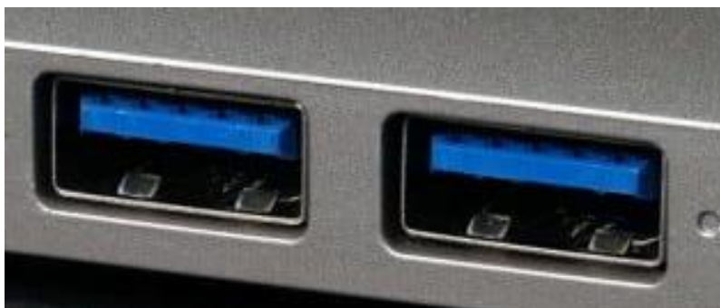
Figura 24. Ejemplos de puerto con interfaz del tipo USB. - Tomado de Imágenes de Google.
