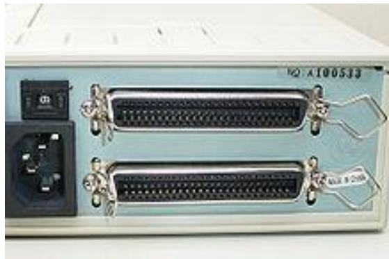
Figura 22. Ejemplo de un puerto con interfaz del tipo SCSI. - Tomado de Imágenes de Google.
