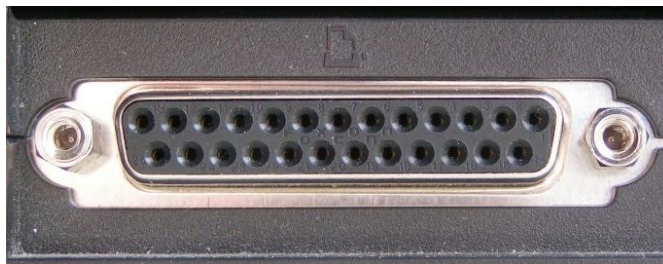
Figura 21. Ejemplo de un puerto con interfaz de tipo paralela. - Tomado de Imágenes de Google.
