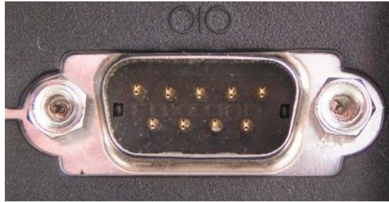
Figura 20. Ejemplo de un puerto con interfaz tipo serial. - Tomado de Imágenes de Google.
