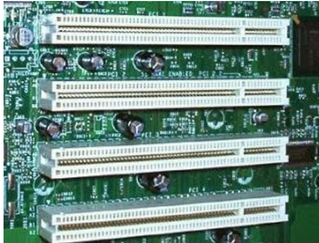
Figura 23. Ejemplos de puertos con interfaz del tipo PCI. - Tomado de Imágenes de Google.
