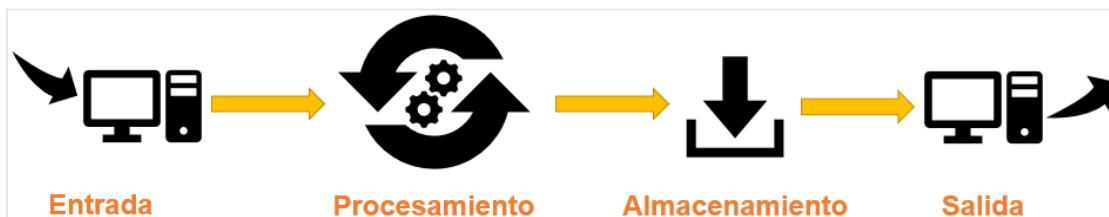
Figura 11. Procesos que forman parte de funcionamiento del computador. - Adaptado de (Stallings, 2010).
