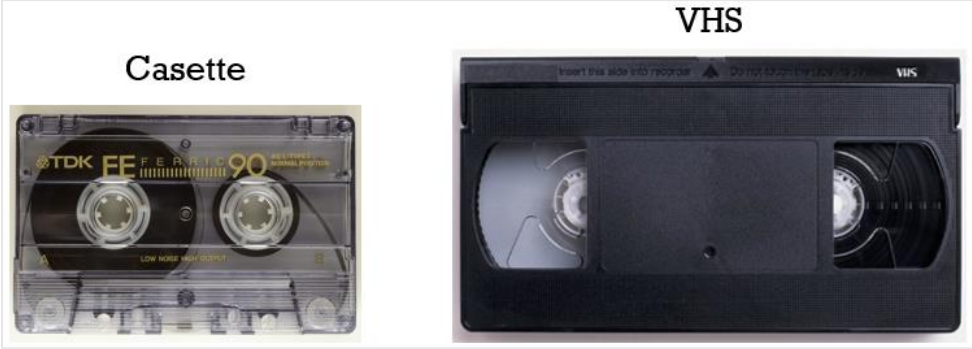
Figura 34. Ejemplos de dos dispositivos de almacenamiento que utilizan cintas magnéticas. - Tomado y adaptado de Imágenes de Google.
