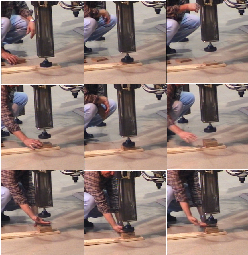
Figura 6.7 Secuencia fotográfica mostrando la detección de obstáculos (en este caso por la pata 2 de ROBOCLIMBER).
